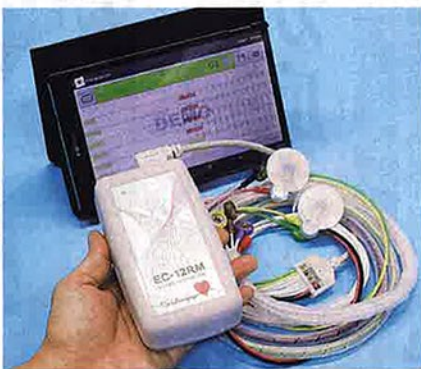
心電図伝送システム「SCUNA」の心電計（手前）と伝送に使うタブレット端末
