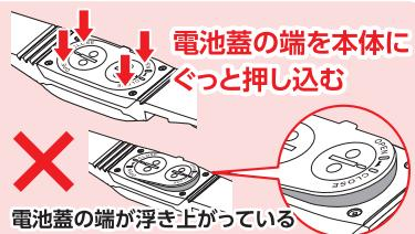
**△注意** 電池蓋の端が浮き上がるなど、閉め方が不完全な場合、本装置の防水性能が損なわれ、故障の原因となります。
